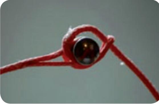
Wichtig ist, dass die Leinen alle in der Rille des ELC verlaufen. Vergleiche das Ergebnis mit dem Bild und prüfe die Verbindung auf sicheren Halt.
