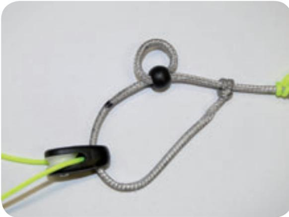
Die Verstellung der B und C Leine funktioniert folgendermaßen: Löse die Position der Kunststoff-Kugel, in dem du die durch sie geschlungene Leine lockerst. Je nachdem ob die Leine kürzer oder länger werden soll, verschiebe die Kugel in die gewünschte Richtung und ziehe sie wieder fest.
