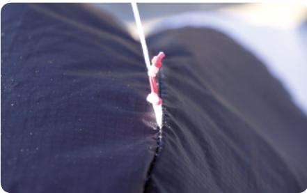
Little Connection Lines (LCL) ermöglichen ein schnelles Auswechseln einer Waageleine und dienen als Sollbruchstelle, um Beschädigungen an der Kappe zu vermeiden. Sollte eine LCL reißen, tausche sie nur mit einer neuen, gleichfarbigen (gleiche Bruchlast) LCL aus.
