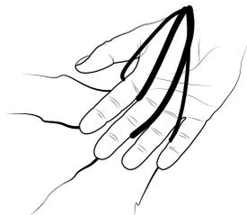
② En partant du bord d'attaque démelez le bridage. Connectez les lignes avant (grises) au bout du bridage avec une tête d'allouette comme indiqué sur la photo. Connectez les lignes arrières (rouge et verte) avec une tête d'allouette autour du noeud de la bride attachée à l'oreille de l'aile.
