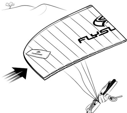
**2** Aprite il kite e se necessario chiudete le valvole. Srotolate i cavi dalla barra mentre vi allontanate dal kite.
