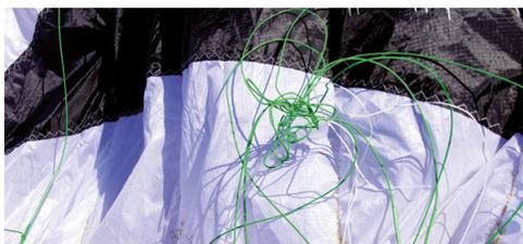
3 Il est possible que le bridage d'un côté passe dans le bridage opposé.
