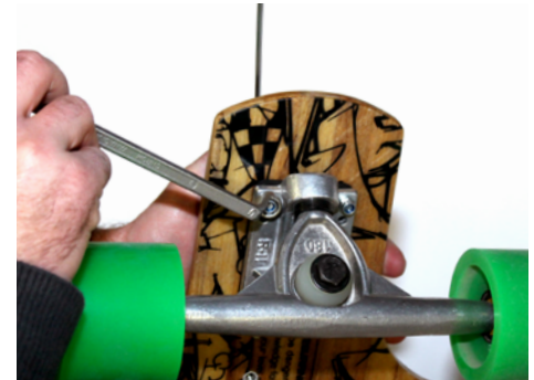
4. Unterlegscheiben aufsetzen und Muttern festziehen
