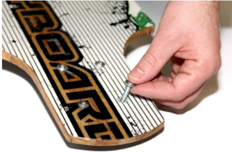
1. Schrauben durch die Bohrungen im Deck stecken
