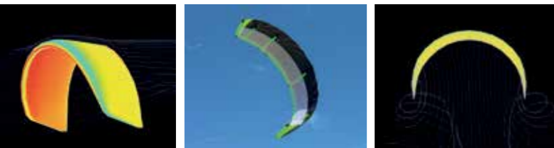
▲ Forschen statt tüfteln (v.l.n.r.): Druckverteilung, Hybrid-Tubekite-Proto mit halb Doppelsegel und verwölbbarem Profil, Stromlinien im Nachlauf mit Randwirbel am Tip
